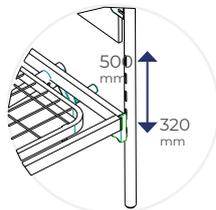
■ Regolazione altezza del piano rete / Wire bed frame height adjustment
